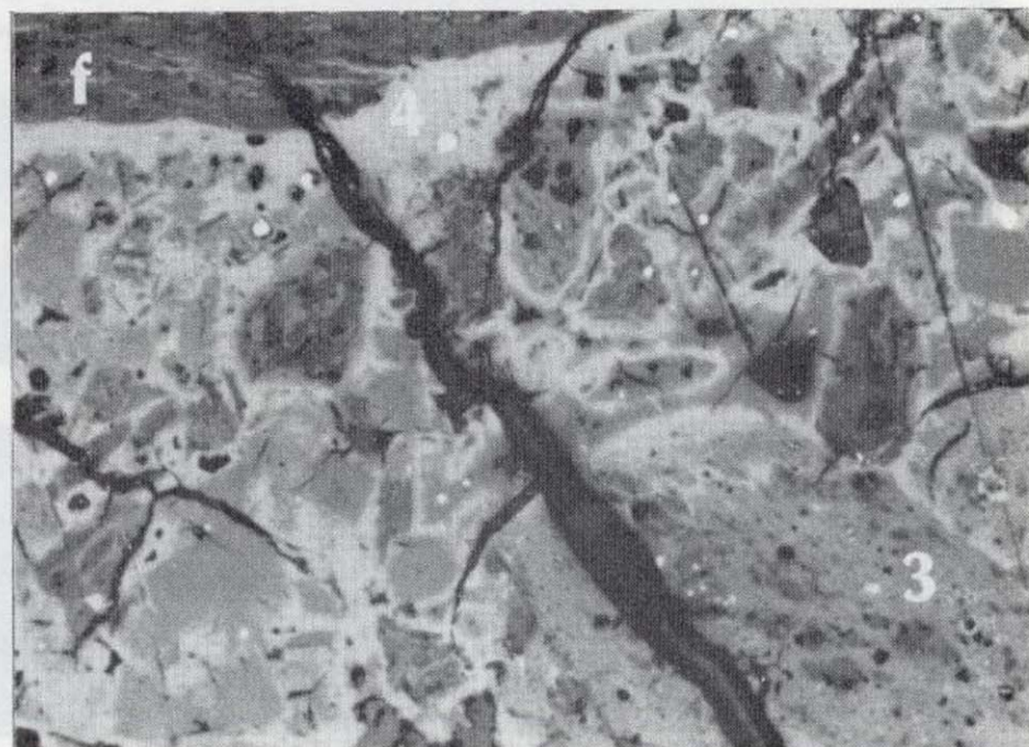
Figura 15.—SP 2588×130. L. N. Brecha «Smirnof». P-I(3), P-II(4) y fragmentos de filita (f).
