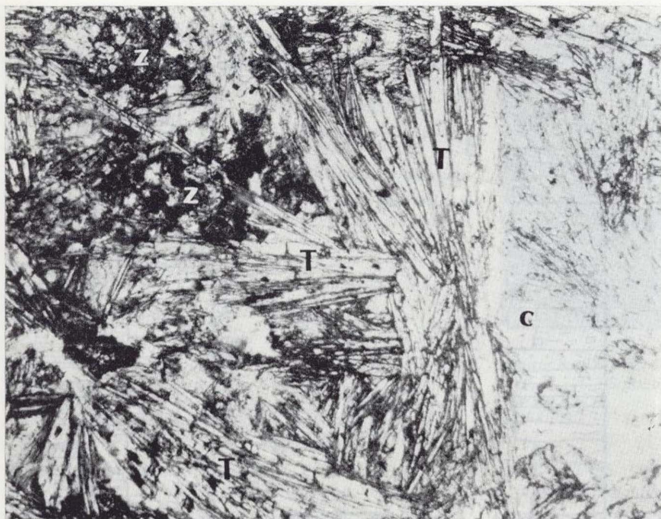
Figura 4.—Sección delgada. L.N. \times 65. Campo microscópico de una roca con silicatos cálcicos. Agregados ramosos de tremolita (T), cuarzo (c) y clinozoisita (z).
